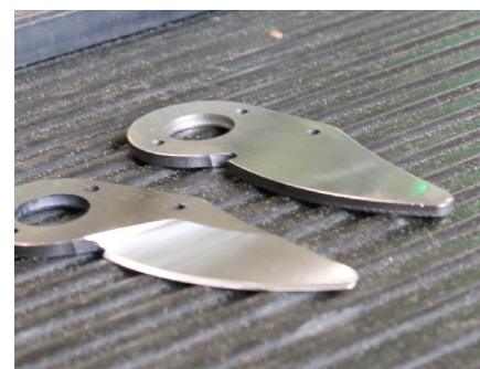
L'atelier de meulage réalise le tranchant des lames des outils coupants
