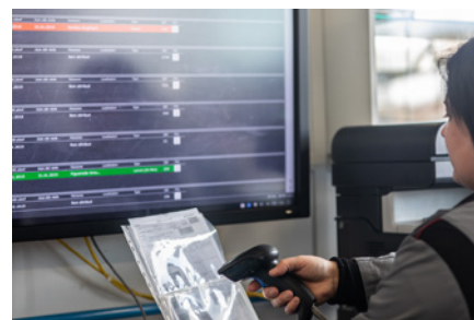
Les ordres de fabrication sont scannés et instantanément importés dans le système ScreeN
